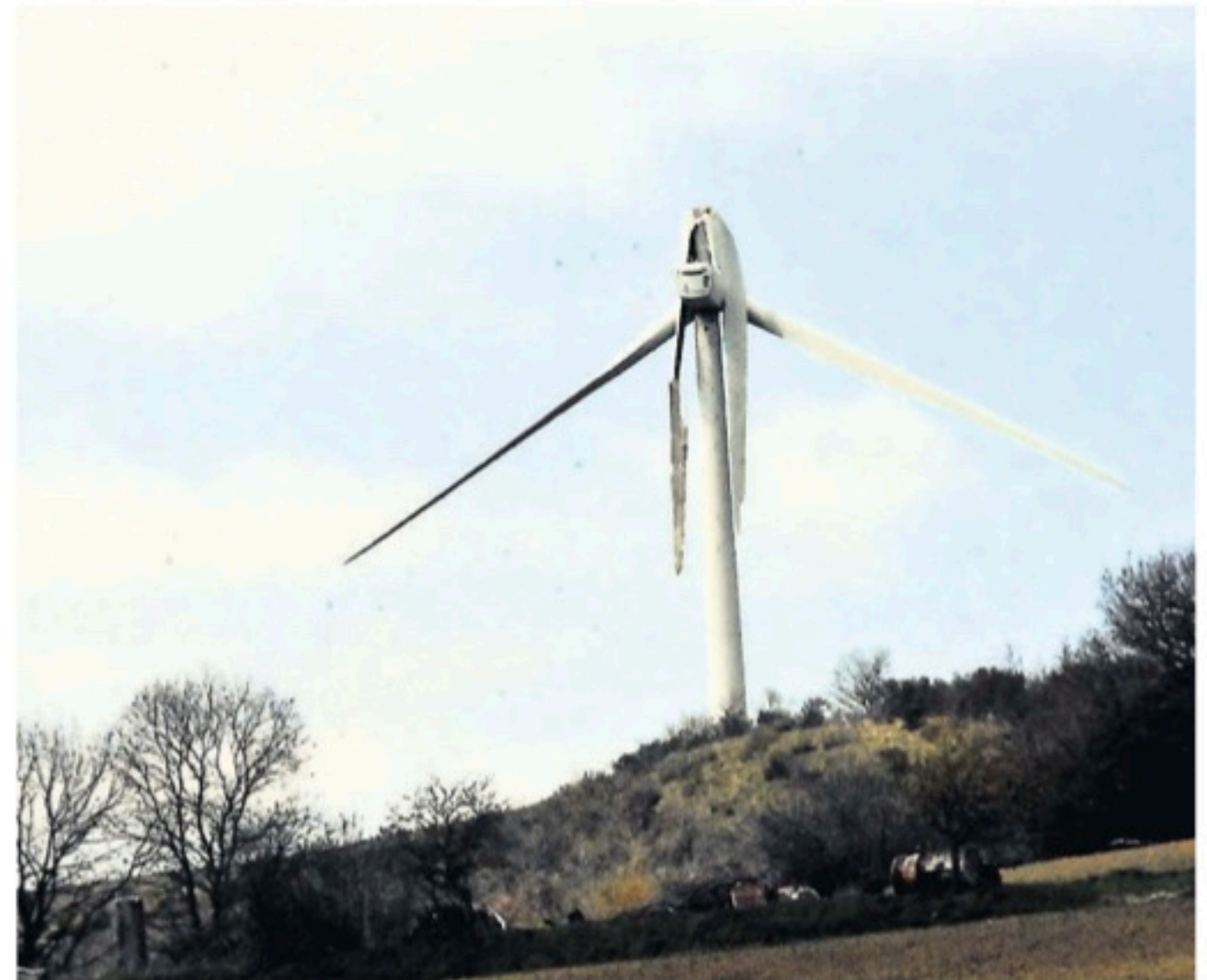
Début avril 2022, une pale d'éolienne de 40 m, du parc de Saint-Félix-Lauragais en Haute-Garonne, s'est pliée. / DDM, E.G.
