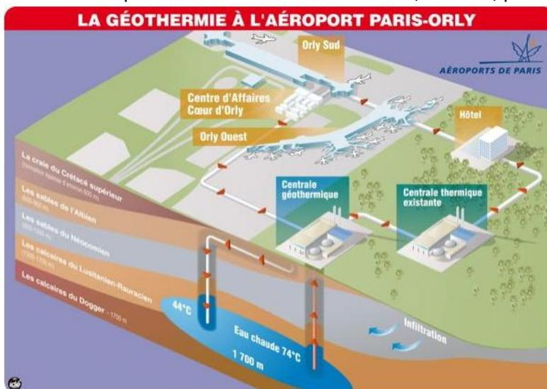
On réinjecte en effet la même eau que celle qu'on a prélevée, évitant à l'environnement d'être atteint par d'éventuelles propriétés physico-chimiques de l'eau souterraine). Cette installation exploite la nappe aquifère présente dans la couche géologique du Dogger, à 1800 mètres de profondeur.
