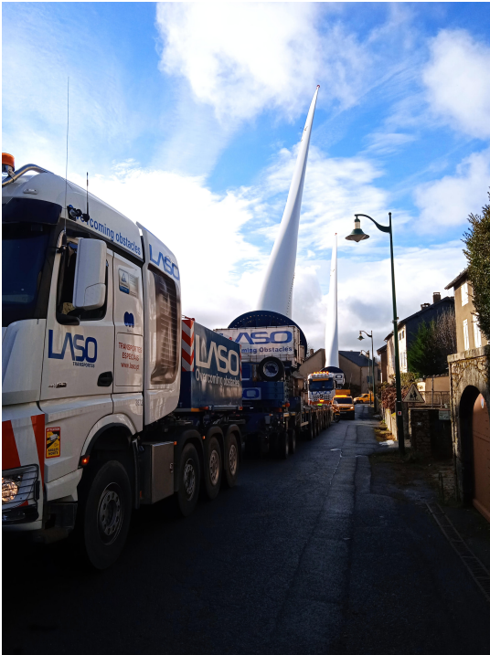
Transport de deux pales d'éoliennes de 45 m dans les rues d'Anglès (Tarn)
