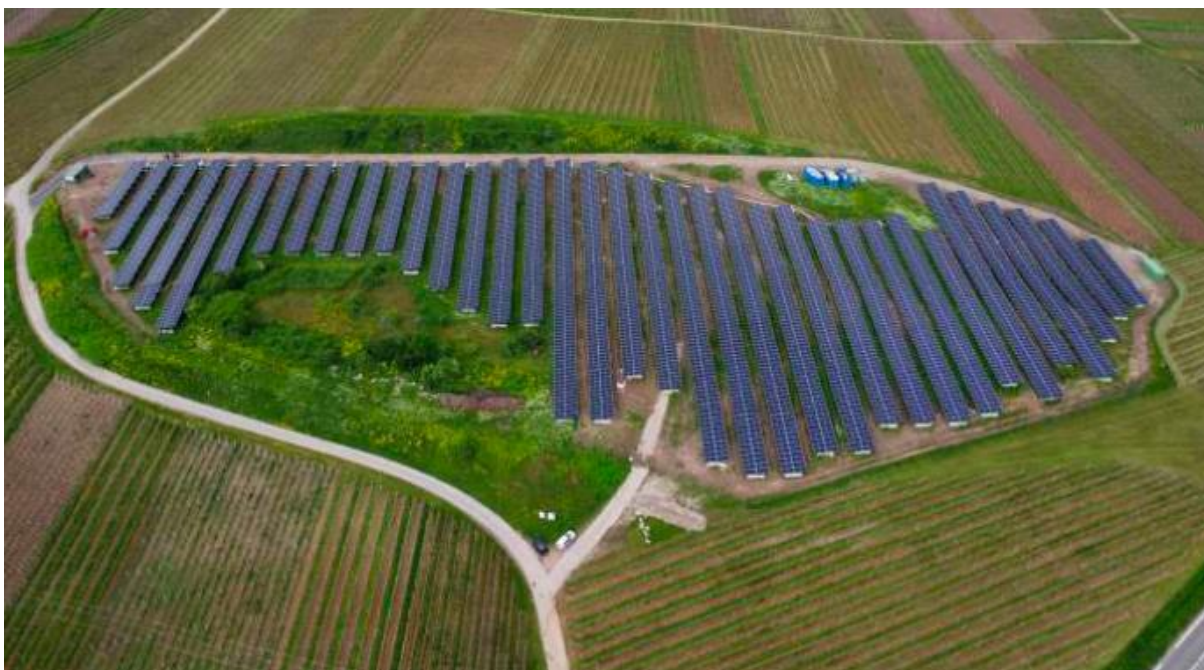
Figure 9. « Valorisation » d'une friche agricole à Katzenthal, Haut-Rhin, d'après les termes du rapport du WWF France 72 . Cette friche était une ancienne carrière ensuite convertie en centre d'enfouissement technique. Puisque l'habitat le plus patrimonial a été évité lors de la conception du projet, cette centrale est présentée comme un exemple de prise en compte de la biodiversité par le rapport. Un écologue tendra plutôt à considérer la disparition de la majeure partie du seul habitat refuge dans une matrice de grande culture très peu hospitalière pour la vie sauvage. Photographie issue du rapport du WWF.
